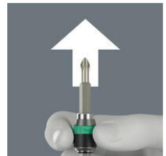
Para cambiar la punta simplemente se ha de desplazar el casquillo hacia adelante: En ese instante, el mecanismo de muelle separa la punta del imán y desbloquea así la herramienta. La punta se puede extraer sin problema alguno. Y lo que es especialmente útil: esta función también permite la extracción de puntas de dimensiones muy pequeñas sin que se tenga que utilizar herramienta adicional de ayuda.
