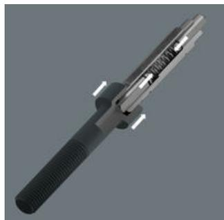
Con ayuda de la punta cuatro-en-una 9506 se pueden accionar cuatro tamaños de tornillos de hexágono interior (3,0; 4,0; 5,0; 6,0). Para poder utilizar el perfil mayor respectivo, al atornillar se ha de presionar continuamente contra la fuerza de resorte, así el perfil menor se hunde, y el perfil mayor puede ser colocado.
