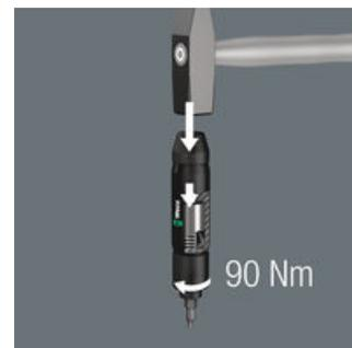
Tiene que ser posible aflojar cualquier tornillo, aunque esté tremendamente agarrotado. Los destornilladores de golpe son la solución para aquellos casos en los cuales no alcanza la fuerza manual y no se tiene a disposición una máquina neumática. El destornillador de golpe de Wera dispone de un grado de efectividad especialmente alto gracias a su construcción de doble curva: la fuerza del golpe es transformada en un movimiento de giro. Así se evita tener que utilizar máquinas de aire comprimido.
