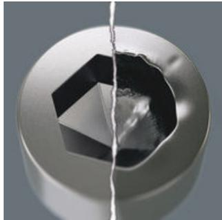
Los tornillos de hexagonal interior son problemáticos ya que las superficies de apoyo por medio de los cuales se transmite la fuerza de la herramienta al tornillo, son sumamente estrechas. Como consecuencia puede ser que se estropee la cabeza del tornillo. Las herramientas tipo Hex-Plus disponen de unas superficies de apoyo de mayores dimensiones que evitan esta clase de daños. Y no está de más recordarlo: ¡Las herramientas Hex-Plus caben en cualquier tornillo hexagonal estándar!
