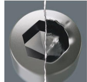
Por medio de la utilización de puntas de acero inoxidable se previene la formación de óxido en tornillos o superficies de acero inoxidable. La contaminación en el acero inoxidable, ante todo se forma por la abrasión al realizar trabajos de atornillado con herramientas convencionales de acero. La abrasión produce partículas de acero fuertemente adherentes que bajo el efecto de oxígeno se convierten en óxido.
