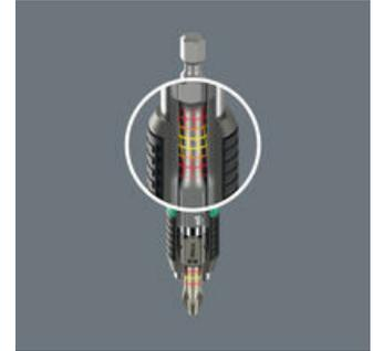
La zona de torsión que está integrada en el porta-puntas BiTorsion, sirve para amortiguar picos menores de par (fase 1). Un mecanismo de apoyo se ocupa de manera efectiva de proteger la zona de torsión ante una sobrecarga.
