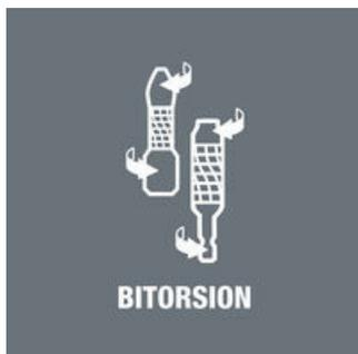
En trabajos de atornillado mecánico, las puntas y los porta-puntas se ven expuestos a unos picos de par extremadamente altos lo que frecuentemente conlleva un fuerte desgaste de las puntas, o incluso la destrucción del tornillo. Si se logra minimizar estos picos de par, el atornillado se convierte más productivo y seguro. El sistema BiTorsion de Wera previene el desgaste prematuro. Se alarga la vida útil de la herramienta, y la productividad del atornillado mecánico aumenta considerablemente.
