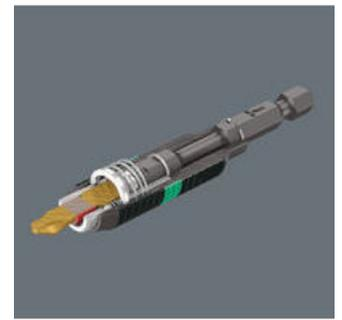
El efecto del sistema BiTorsion se basa en la combinación de dos elementos de muelle que son capaces de absorber los choques. Tanto las puntas como el porta-puntas disponen de una zona de torsión amortiguadora que en el caso de picos de par, transporta la energía cinética alejándola del extremo de la punta.
