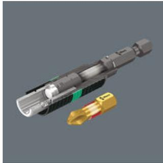
Las características óptimamente compaginadas de las zonas de torsión de la punta y del porta-puntas, permiten una elasticidad paulatina bajo una carga. Este sistema de dos fases evita un desgaste prematuro. Además, la dureza de las puntas optimizada para cada una de las aplicaciones correspondientes, garantiza una larga vida útil de la herramienta.
