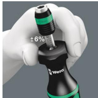
Un ajuste manual muy simple, del valor de par de apriete necesario. La exactitud de medición está en  $\pm 6\%$  según la norma EN ISO 6789. Se oye y se palpa claramente el "clic" tan pronto se alcanza el par de apriete ajustado.
