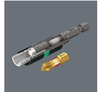
Las características óptimamente compaginadas de las zonas de torsión de la punta y del porta-puntas, permiten una elasticidad paulatina bajo una carga. Este sistema de dos fases evita un desgaste prematuro. Además, la dureza de las puntas optimizada para cada una de las aplicaciones correspondientes, garantiza una larga vida útil de la herramienta.
