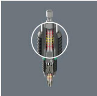
La zona de torsión que está integrada en el porta-puntas BiTorsion, sirve para amortiguar picos menores de par (fase 1). Un mecanismo de apoyo se ocupa de manera efectiva de proteger la zona de torsión ante una sobrecarga.
