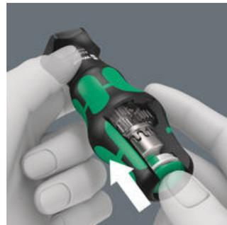
La función turbo puede activarse según las necesidades con sólo pulsar un botón. Se recomienda desactivarlo para apretar y aflojar con un par de apriete elevado, por ejemplo al atornillar madera, así como para el ajuste fino.
