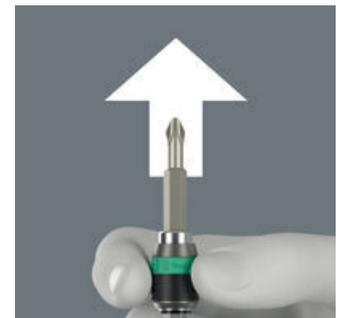
Para cambiar la punta simplemente se ha de desplazar el casquillo hacia adelante: En ese instante, el mecanismo de muelle separa la punta del imán y desbloquea así la herramienta. La punta se puede extraer sin problema alguno. Y lo que es especialmente útil: esta función también permite la extracción de puntas de dimensiones muy pequeñas sin que se tenga que utilizar herramienta adicional de ayuda.
