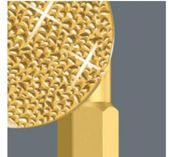
Las partículas minúsculas de diamante que han sido aplicadas en el extremo de la punta, durante el proceso de atornillado se aferran fuertemente al tornillo y permiten un alojamiento exacto y seguro contra el deslizamiento, dentro de la cabeza del tornillo. Este alojamiento seguro sirve para proteger el tornillo, ya que permite una importante reducción de las fuerzas de expulsión, que normalmente obligan al usuario a ejercer una presión muy alta en el tornillo.
