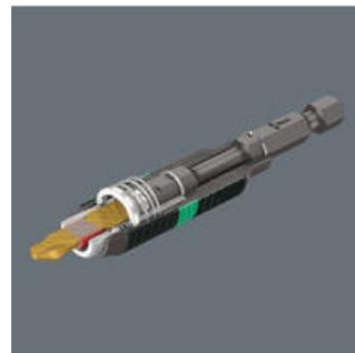
El efecto del sistema BiTorsion se basa en la combinación de dos elementos de muelle que son capaces de absorber los choques. Tanto las puntas como el porta-puntas disponen de una zona de torsión amortiguadora que en el caso de picos de par, transporta la energía cinética alejándola del extremo de la punta.
