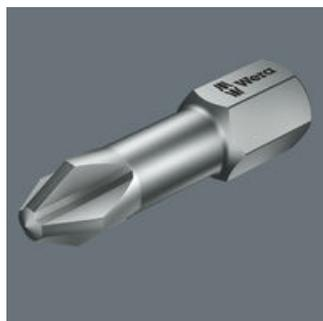
Puntas TZ son puntas extrarresistente con zona de torsión. Las puntas de torsión amortiguan los picos del par de giro en la zona de torsión. Así se evita un desgaste prematuro, y se aumenta la longevidad de la punta.
