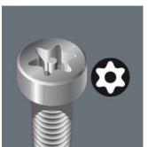
Ha sido construido para evitar que las así llamadas uniones atornilladas de seguridad se desmonten sin autorización. Para que no sea posible la utilización prohibida de herramientas TORX® comunes, los tornillos, en su perfil de arrastre disponen de un pivote. Este pivote se aloja dentro del taladro de las herramientas TORX® BO, y así sí es posible aflojar la unión de seguridad.
