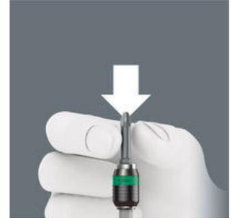
Sin accionar el casquillo se puede encajar la punta en el porta-puntas. En el momento en el que la punta se coloca en el tornillo, automáticamente se activa el bloqueo. Ahora la punta queda alojada de forma segura y sin tambaleo.
