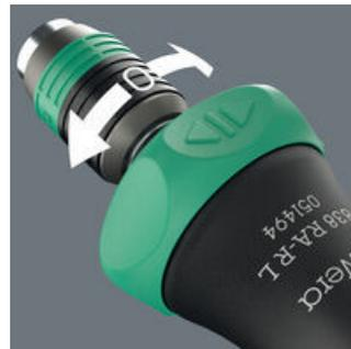
La conmutación del sentido de giro sucede de forma intuitiva: al girar el conmutador anular hacia la derecha, se atornilla en dirección hacia la derecha, y al girar el conmutador anular hacia la izquierda, se atornilla hacia la izquierda.
