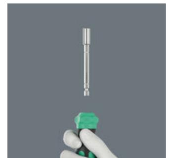
Al accionar de nuevo el manguito de bloqueo de forma más energética, se dispara el mecanismo de salto por medio de la superación claramente audible y palpable de la resistencia de bloqueo. Ahora, la varilla telescópica puede extraerse, y se puede insertar en la máquina atornilladora como adaptador de puntas.
