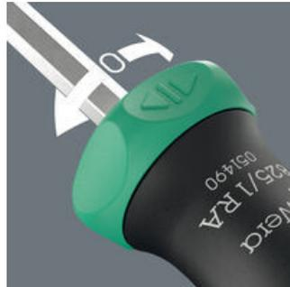
La conmutación del mecanismo de carraca sucede de forma intuitiva. Al girar el conmutador giratorio hacia la derecha, se atornilla en dirección hacia la derecha, y al girar el conmutador hacia la izquierda, se atornilla hacia la izquierda. Para realizar trabajos de precisión, el mecanismo de carraca puede desactivarse por medio de la posición 0.
