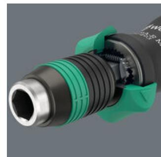
La carraca que viene integrada lleva un dentado fino y permite un trabajo rápido y seguro. El mecanismo de carraca viene integrado de forma completa dentro del mango. El mango es muy compacto en sus dimensiones, lo cual permite un uso de la carraca incluso en situaciones de trabajo y montaje muy estrechas.
