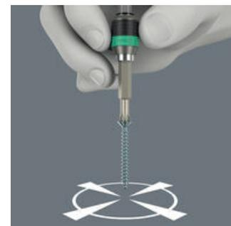
Gracias al casquillo de giro libre, durante el proceso de atornillado, el usuario puede guiar la máquina de atornillar, ya sea de acumulador o eléctrica, sosteniendo el manguito. Esto facilita la colocación de la punta en el tornillo, y evita así que se deslice de la cabeza del tornillo. Utilizable también como prolongación corta con casquillo de giro libre en aplicaciones de 1/4", por ejemplo en combinación con la carraca de puntas de Wera, o la carraca Zyklus.
