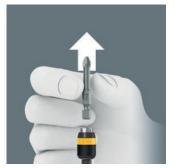
cambiar Para la punta simplemente se ha de desplazar el casquillo hacia adelante: En ese instante, el mecanismo de muelle separa la punta del imán y desbloquea así la herramienta. La punta se puede extraer sin problema alguno. Y lo que es especialmente útil: esta función también permite la extracción de puntas de dimensiones muy pequeñas sin que se tenga que utilizar herramienta adicional de ayuda.
