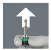
Para cambiar punta la simplemente se ha de desplazar el casquillo hacia adelante: En ese instante, el mecanismo de muelle separa la punta del imán y desbloquea así la herramienta. La punta se puede extraer sin problema alguno. Y lo que es especialmente útil: esta función también permite la extracción de puntas de dimensiones muy pequeñas sin que se tenga que utilizar herramienta adicional de ayuda.
