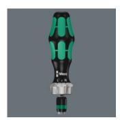
Destornillador de carraca, dentado fino para un mínimo ángulo de retorno, anillo de conmutación (derecha, fijo, izquierda), par máximo de hasta 50 Nm; arrastre hexagonal interior de 1/4" con tecnología Rapidaptor funciones rapid-in, rapid-out, rapidspin, chuck-all y una sola mano para un cambio de puntas ultrarrápido, magnético, adecuado para puntas de arrastre hexagonal exterior de 1/4" según DIN ISO 1173-C 6,3 y E 6,3 y series de conexión de Wera 1 y 4
