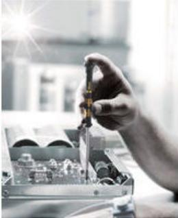
Al realizar trabajos de atornillado en componentes electrónicos (como por ejemplo, en teléfonos móviles o tabletas) tiene que evitarse que se produzcan descargas electrostáticas ya que esto puede causar malfunciones, o, en el peor de los casos, la avería total del aparato electrónico. Por eso es indispensable utilizar herramientas de atornillar que estén aseguradas electrostáticamente.
