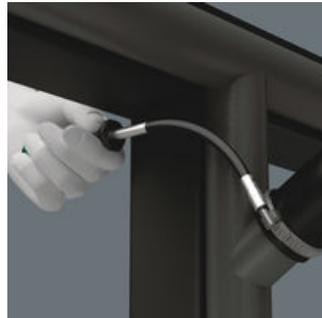
Con ayuda del destornillador 392 también es posible realizar trabajos de atornillado "doblado la esquina". Gracias al eje flexible, es posible acceder a tornillos que se encuentran posicionados en lugares complicados. Es el útil ideal para trabajos de apriete de difícil acceso, por ejemplo, en el vano motor de un automóvil.
