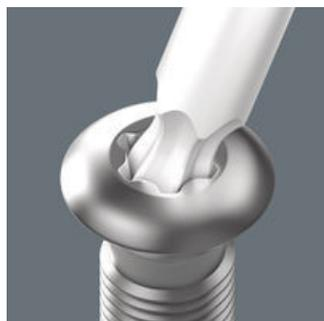
Gracias al extremo esférico, es posible realizar movimientos desplazados del eje de la herramienta con el eje del tornillo, así que prácticamente es posible realizar un atornillado "a la vuelta de la esquina".
