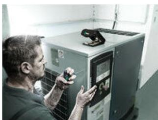
La mecánica de carraca del portapuntas manual con mango en "T" 416 RA está completamente integrada en el mango. La forma compacta del útil permite un trabajo manejable y práctico.
