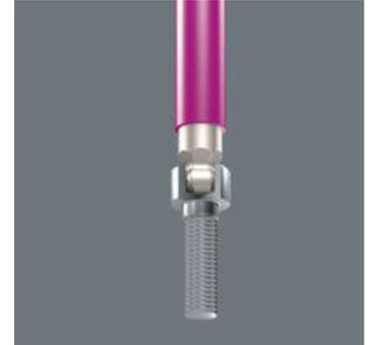
La sujeción del tornillo de hexágono interior en la llave acodada se realiza por medio de una bola. Este útil es especialmente adecuado para situaciones de trabajo de difícil acceso en las cuales no es posible utilizar la mano libre para sostener el tornillo.
