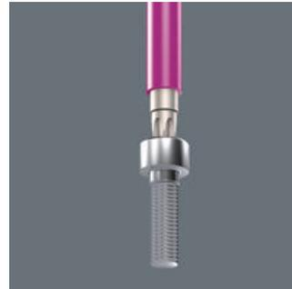
Las herramientas TORX® HF desarrolladas por Wera se caracterizan por una optimización geométrica del perfil original tipo TORX®. Gracias a la fuerza de apriete que resulta de la presión superficial entre la punta de salida y el perfil del tornillo, los tornillos TORX®, fabricados bajo las especificaciones de Acument Intellectual Properties, se mantienen seguros en la herramienta.
