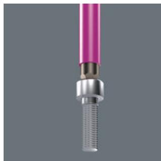
La sujeción del tornillo de hexágono interior en la llave acodada se realiza por medio de una bola. Este útil es especialmente adecuado para situaciones de trabajo de difícil acceso en las cuales no es posible utilizar la mano libre para sostener el tornillo.
