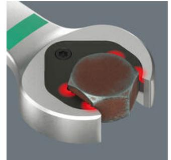
La inteligente geometría de doble hexágono de la Joker produce una unión perfecta y continua con el tornillo o la tuerca: ¡esto sí que encaja bien! Y la placa metálica intercambiable y endurecida, de la que dispone la boca de la Joker, con ayuda de sus puntas extremadamente duras, se aferra fuertemente al tornillo. Ambas cosas evitan las molestias que provocan los deslizamientos incluso en pares de apriete muy elevados.
