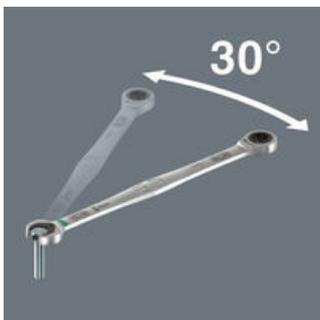
Por medio de la geometría de doble hexágono del extremo de la boca, el ángulo de retorno de la carraca Joker 6007 se reduce a 30°. La Joker 6007 dispone de una boca recta, así que ya no hace falta darle la vuelta y volver a posicionarla constantemente lo que complicaba el trabajo.
