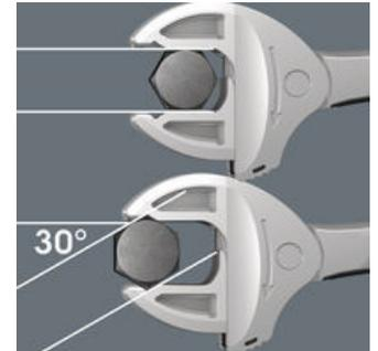
Por medio de los prismas angulares dentro de las dos bocas de la llave de doble boca, se consigue un ángulo de retorno de tan solo 30°.
