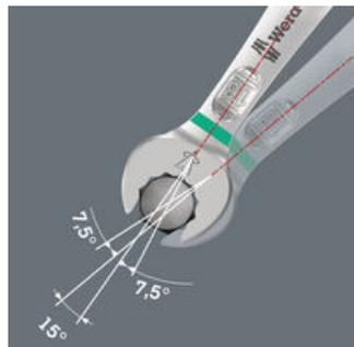
Gracias a la boca en un ángulo de 7,5°, a la geometría de doble hexágono y a un método de aplicación ajustado (posicionar, atornillar, voltear, volver a posicionar, atornillar, voltear...) es incluso posible solucionar aquellas situaciones en las cuales se tiene que trabajar con ángulos de retorno de menos de 30°.
