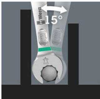
La llave de anillo y boca Joker 6003 con su geometría de boca especial (en un ángulo de 7,5° y doble hexágono) duplica las posibilidades de posicionamiento durante las repetidas vueltas de la llave en 180° por el eje longitudinal. Así, las tuercas y los tornillos pueden ser accionados cada 15°. El punto de posicionamiento correspondiente lo encuentra esta llave Joker 6003 de forma autónoma tras cada vuelta que se le da.
