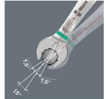
Gracias a la boca en un ángulo de 7,5°, a la geometría de doble hexágono y a un método de aplicación ajustado (posicionar, atornillar, voltear, volver a posicionar, atornillar, voltear...) es incluso posible solucionar aquellas situaciones en las cuales se tiene que trabajar con ángulos de retorno de menos de 30°.
