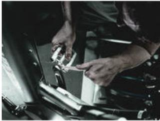
6003 Joker Pedal tamaño 15 con boca plana para montar y desmontar los pedales
