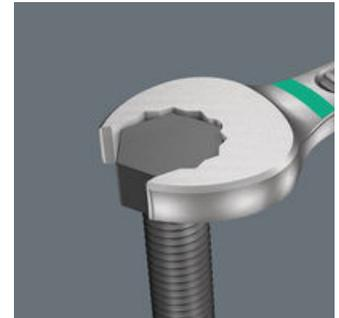
La geometría de doble hexágono en ambos lados, o sea en anillo y boca, asegura la conexión completa y perfecta del útil con la cabeza del tornillo o con la tuerca, minimizando así el riesgo de que la herramienta se resbale durante el trabajo de atornillar.
