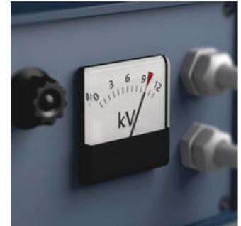
La prueba individual pieza por pieza a 10.000 voltios según la norma IEC 60900 garantiza un trabajo seguro bajo tensiones de hasta 1.000 voltios.
