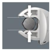
Las mordazas lisas y paralelas de la llave Joker 6004 permiten una presión sobre las superficies, y de esta forma pueden evitar un redondeo de la tuerca o de la cabeza del tornillo, un fenómeno que puede suceder en la transmisión de fuerzas a lo largo de ángulos.
