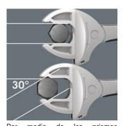
Por medio de los prismas angulares en la boca se logra un ángulo de retorno de tan solo 30°.
