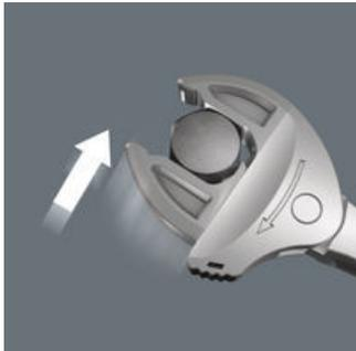
Por medio de sus mordazas paralelas de agarre automático y continuo, la llave de boca Joker 6004 es capaz de sustituir todas las llaves dentro del área de medidas que se indica. La llave es capaz de encontrar el tamaño preciso de forma autónoma al posicionarse en el tornillo o la tuerca sin necesidad de ajuste.
