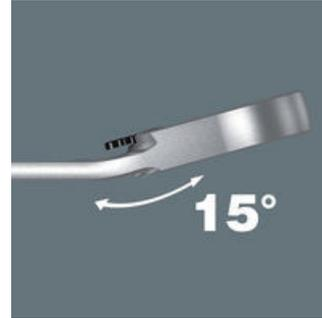
El extremo del anillo está acodado en un ángulo de 15° con relación al eje del útil para facilitar el posicionamiento de la llave en situaciones de montaje de gran estrechez.
