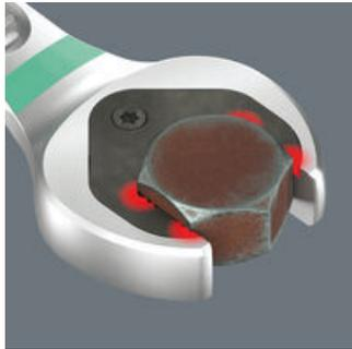
La inteligente geometría de doble hexágono de la Joker produce una unión perfecta y continua con el tornillo o la tuerca: ¡esto sí que encaja bien! Y la placa metálica intercambiable y endurecida, de la que dispone la boca de la Joker, con ayuda de sus puntas extremadamente duras, se aferra fuertemente al tornillo. Ambas cosas evitan las molestias que provocan los deslizamientos incluso en pares de apriete muy elevados.
