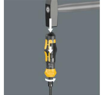
Cuando está conectada la función de destornillador de golpe, el impulso de golpe del martillo es transferido a un movimiento de rotación con un par de desapriete de hasta 25 Nm. La transmisión de la fuerza se realiza sin pérdidas por medio de una varilla pasante.
