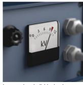
La prueba individual pieza por pieza a 10.000 voltios según la norma IEC 60900 garantiza un trabajo seguro bajo tensiones de hasta 1.000 voltios.
