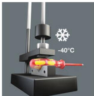
Incluso bajo condiciones extremas de servicio se garantiza la seguridad, gracias a las pruebas de resistencia a impactos a baja temperatura de hasta 40°C bajo cero.
