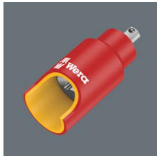
Las llaves de vaso y las prolongaciones Zyklus para electricistas ofrecen una mayor seguridad gracias al aislamiento bicomponente con el núcleo aislante de color amarillo debajo de la capa exterior de aislamiento de color rojo.
