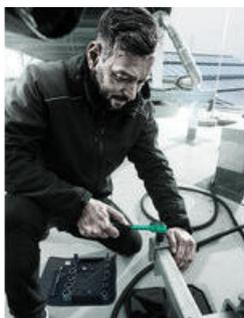
Gracias a su dentado fino de 80 dientes, la carraca Zyklop Comfort permite un ángulo de retorno muy corto de tan solo 4,5°.
