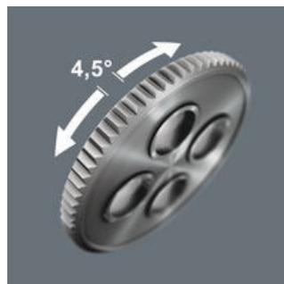
Gracias a su dentado fino de 80 dientes, la carraca Zyklop Comfort permite un ángulo de retorno muy corto de tan solo 4,5°.
