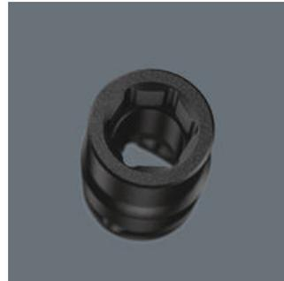
El perfil hexagonal permite la transmisión de altas fuerzas y significa menos carga para los bordes de la tuerca del tornillo, o de la cabeza del tornillo, en comparación con el perfil bihexagonal. Además, gracias al ángulo de retorno mínimo de las carracas de dentado fino, ya no hace falta utilizar el perfil bihexagonal en situaciones de montaje muy estrechas.
