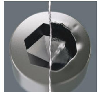
Los tornillos de hexagonal interior son problemáticos ya que las superficies de apoyo por medio de los cuales se transmite la fuerza de la herramienta al tornillo, son sumamente estrechas. Como consecuencia puede ser que se estropee la cabeza del tornillo. Las herramientas tipo Hex-Plus disponen de unas superficies de apoyo de mayores dimensiones que evitan esta clase de daños. Y no está de más recordarlo: ¡Las herramientas Hex-Plus caben en cualquier tornillo hexagonal estándar!
